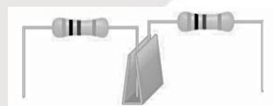
圖 4-1 麵包板連接元件接腳的原理
