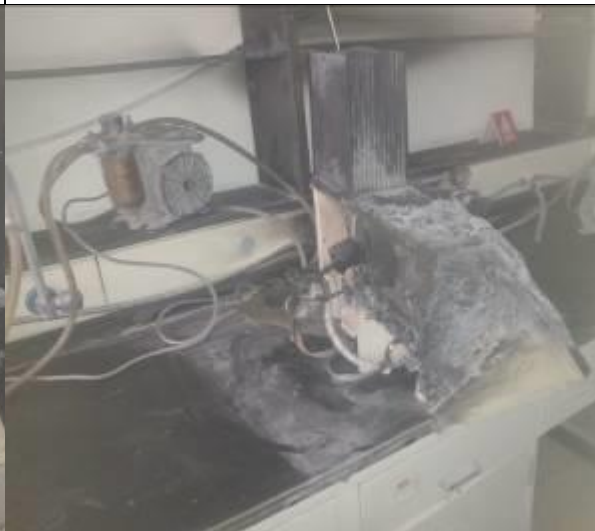
圖 4.損毀之火焰光度計背面(爆出點)，燃燒爆炸後先燒毀儀器上方、上方萬向排氣罩及後方之實驗檯面
