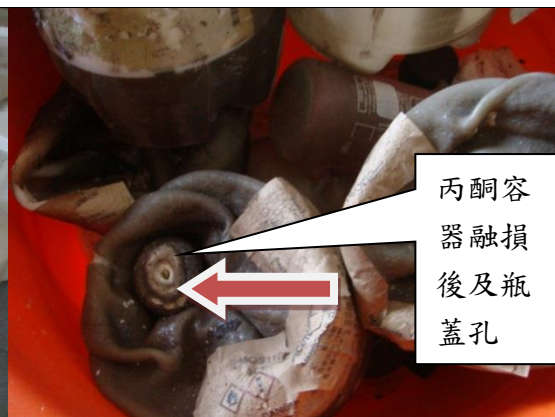
受熱變形丙酮容器可自容器桶身變形與瓶口觀察到蒸汽釋放跡象
