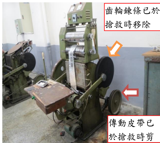
圖 1.發生災害之燙金機 (傳動皮帶已被剪斷、齒輪鍊條已移除)
