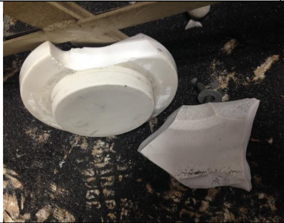
7-球磨鉢蓋及鉢體上方破裂碎片
